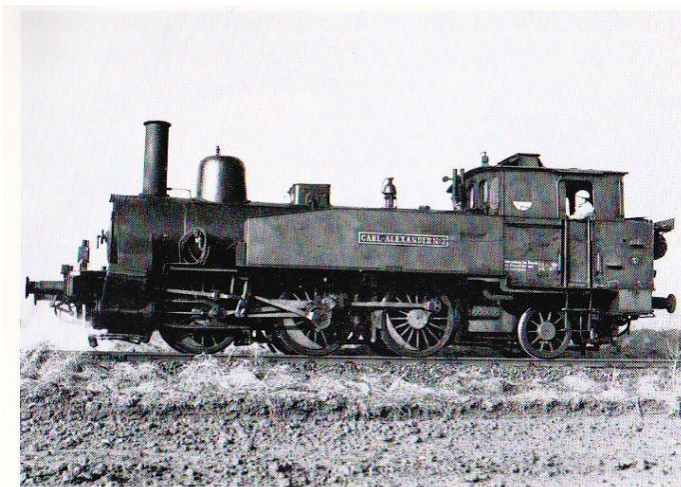
Bild 55: Bis auf das Lokschild fast wie auf der Kleinbahn von einst. Die T 9 1 auf der Verbindungsbahn Grube „Carl-Alexander“ — Bahnhof Merkstein. Deutlich ist auf dem Foto die alte Allan-Steuerung zu erkennen. (Foto: Johannes C. Klossek)
